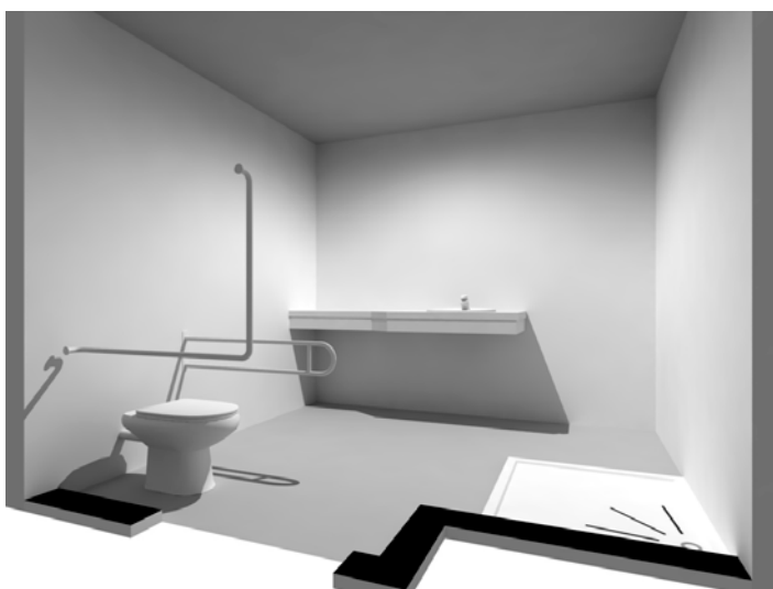
Fig 6.41 – Possibilidade da adaptação da instalação sanitária às necessidades da PMC (ex., colocação de barras de apoio)
