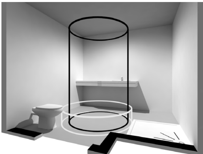
Fig 6.39 – Nível 1: características de uma instalação sanitária por fogo (cilindro negro com \varnothing \geq 1,30 m e h \geq 2,00 m e cilindro branco com \varnothing \geq 1,50 m e h \geq 0,30 m)
