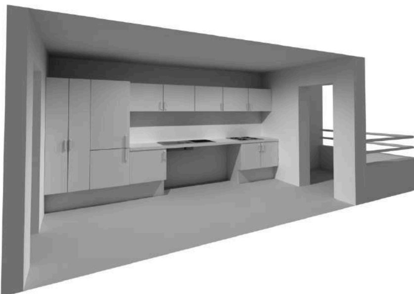
Fig 6.44 –Adaptação da cozinha às necessidades da PMC (espaço livre sob o lava-loiça e junto ao fogão)
